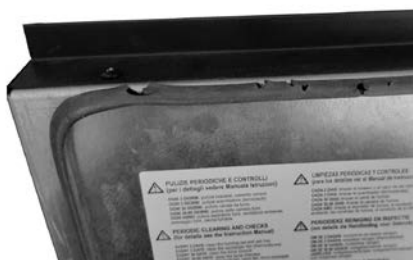
Fig. 21 - Junta deteriorada
